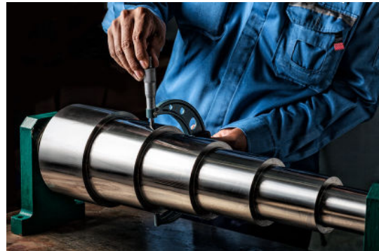
Meten met een beugelschroefmaat
