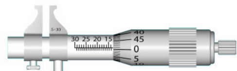
bek-binnenschroefmaat met 5 tot 30 mm meetbereik
