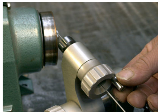
Speciale machine voor het slijpen van een wolfraamelektrode
