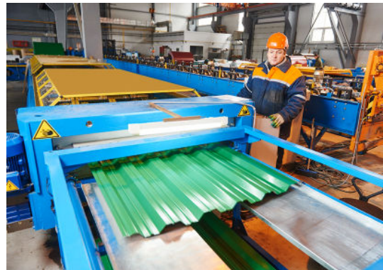
Rolvormstation voor het maken van profielen
