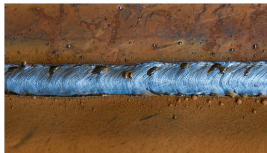
Schilfers op het lasoppervlak
