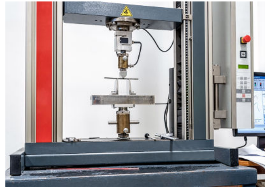
Buigproef met een buigdoorn
