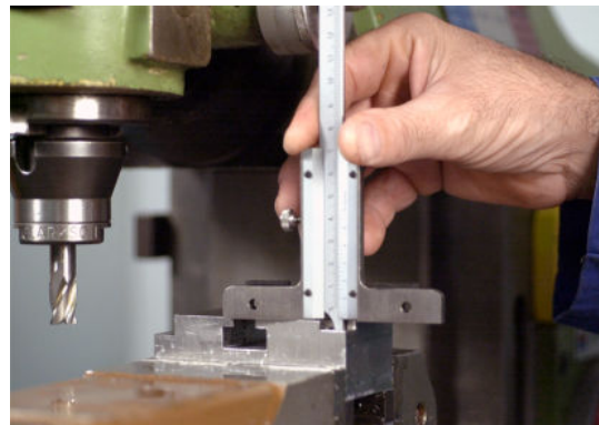
Afmetingen van de uitsparing meten
