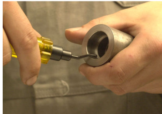
Bramen verwijderen met een schraapstaal
