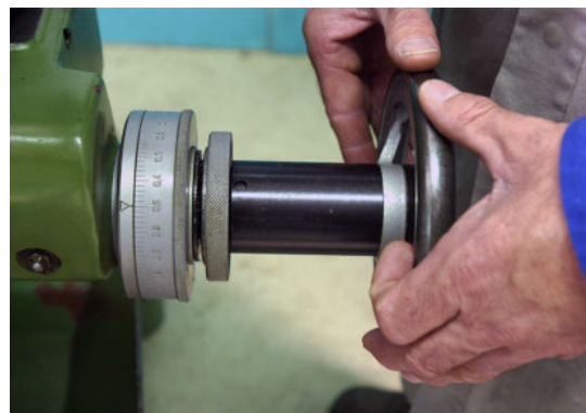
Snedediepte instellen, verticale slede
