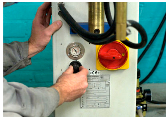
Puntlasmachine instellen afhankelijk van tabel
