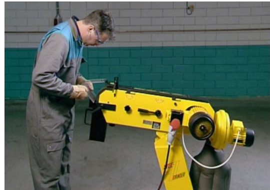
Schuren op een bandschuurmachine
