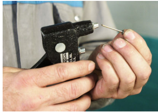
Blindklinknagel in blindklinktang plaatsen
