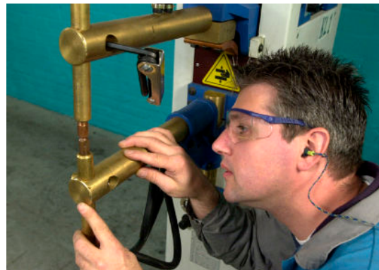
Controleren van de elektroden
