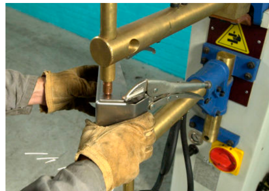
Druk de bovenste elektrode op de plaat
