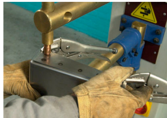
Maak de volgende puntlassen op dezelfde manier
