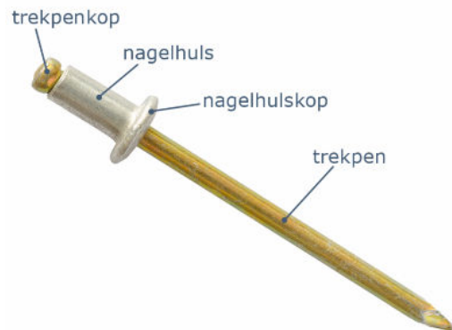
Blindklinknagel van aluminium
