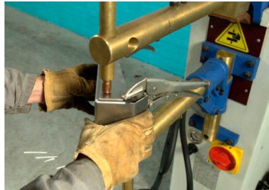
Materiaaldelen verbinden met puntlassen
