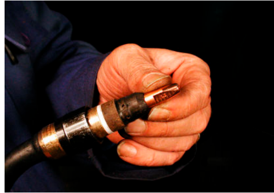
Verwissel de contactbuis bij een andere draaddiameter
