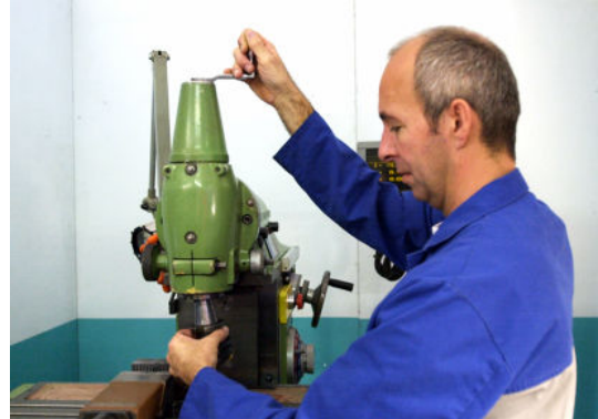
Houd de frees vast totdat je deze goed hebt vastgedraaid
