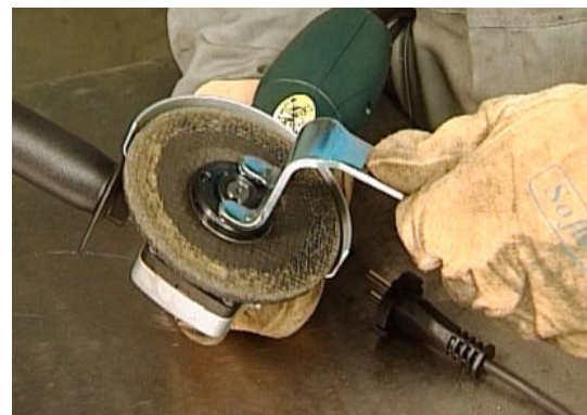
Speciale sleutel voor demontage en montage van de slijpschijf
