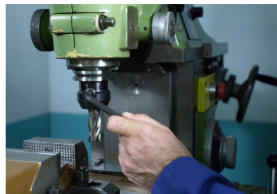
Draai de borgbout voorzichtig vast met een inbussleutel
