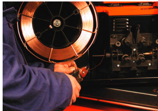
Knip het gebogen uiteinde van de lasdraad af
