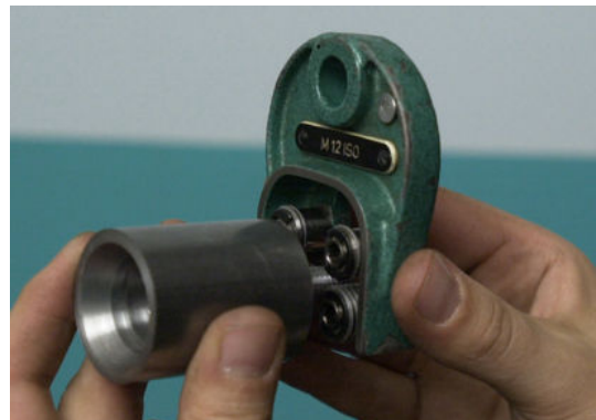
Controle schroefdraad met rolbekkaliber
