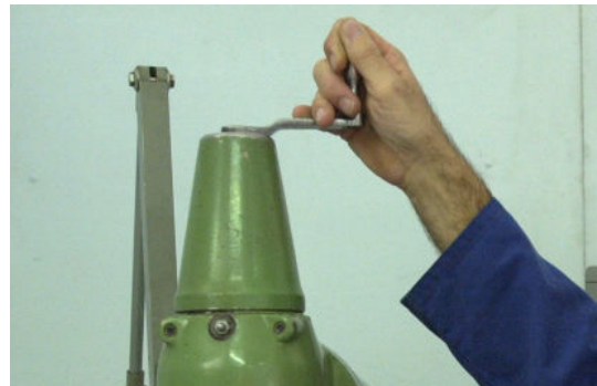
Vergeet niet de slinger uit de hoofdspil te halen
