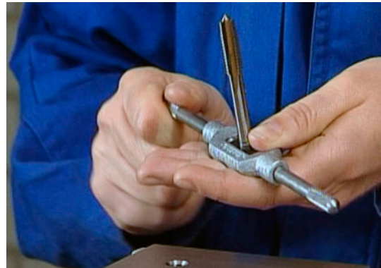
Tap inspannen in wringijzer
