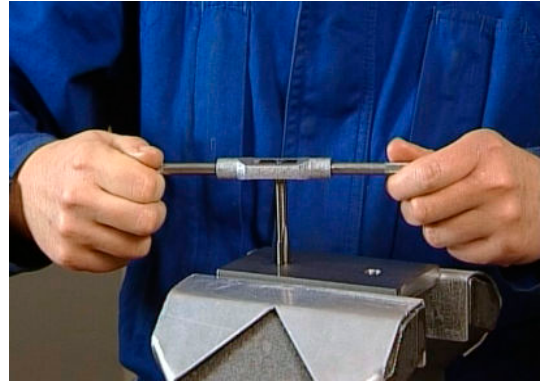
Draai de tap af en toe terug om de spanen te breken
