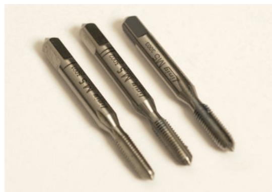
Set handtappentappen voor voorsnijden, tussensnijden en maatsnijden
