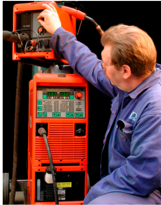
Slangenpakket aangesloten op de draadaanvoer-eenheid
