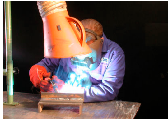
Vlamboog tussen afsmeltende lasdraad en werkstuk
